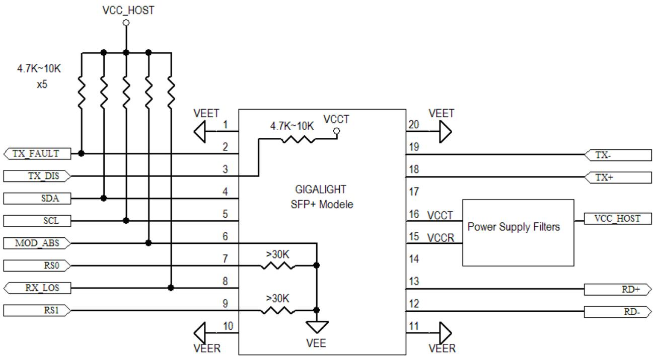
Figure4. Host-Module Interface
